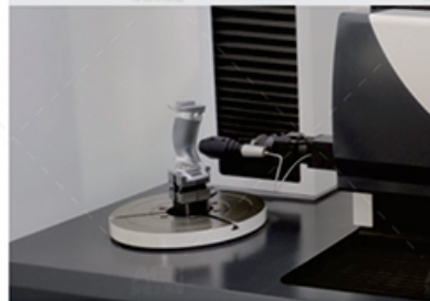
白光干涉+精密转台测量非回转体叶片
